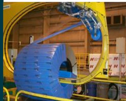
A Coilmaster aplica automaticamente filme através do diâmetro interno da bobina, eliminando contato com ar e outros elementos externos para evitar a corrosão do produto. O filme também protege as bobinas de danos que podem ocorrer durante o manuseio e o empilhamento. As bobinas giram sobre rolos a uma velocidade giram sobre rolos a uma velocidade manualmente predefinida. À medida que a bobina gira, o sistema de transporte viaja em torno da pista, aplicando filme pré-esticado por camada.
