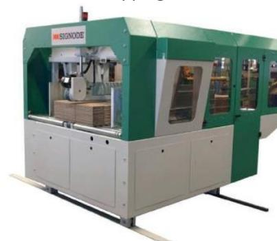
A ISB aumenta a eficiência da produção com alta velocidade de operação e rápida manutenção, devido aos recursos de alinhamento e amarração automáticos. A máquina está disponível em 3 modelos básicos, que acomodam pacotes na largura de 170 a 1300mm, 1600mm e 2000mm. Sua velocidade é de 30 pacotes por minuto, no sentido da onda, enquanto os mesmos saem da impressora (folder-gluer) ou outros equipamentos de acabamento.
