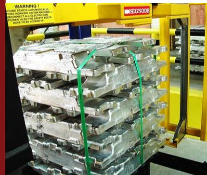
Para lingotes e tarugos de alumínio, a fita PET é aplicada através de equipamentos automático, para cintar qualquer tipo de carga. Isso possibilita que a fita seja aplicada com alta tensão, garantindo transporte estável dos paletes.
